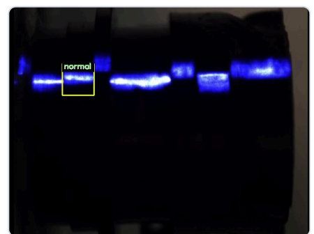
Profilkontrolle des Teils mithilfe einer Laserlinie.
